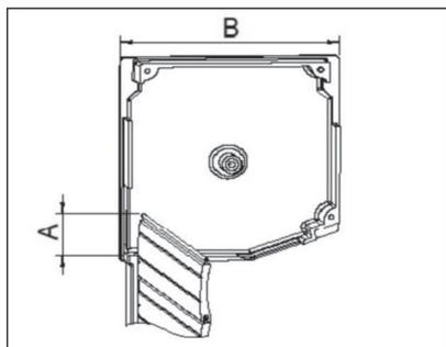
Der oberste Profilstab des Rollladens sollte nicht mehr als 1/2 der Profilhöhe aus der Führungsschiene herauskommen (A).
