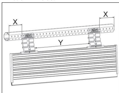
Die Hochschiebesicherungen sollten bei der Montage einen Abstand X von min. 30 mm und max. 80 mm haben.
